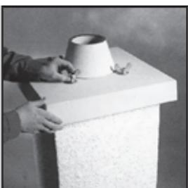
46. Закрепите покровную плиту при помощи винтов.
