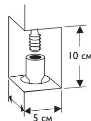
Соединительный стык после монтажа арматурных стержней закрывают цементным раствором
