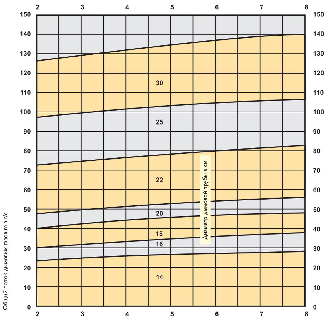
Высота дымоходной трубы от точки подключения верхнего котла Н, м
