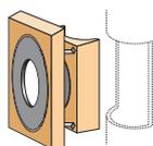
При помощи универсальных соединительных элементов заводской готовности теплогенерирующие установки могут довольно просто подключаться к системе Schiedel Quadro.
