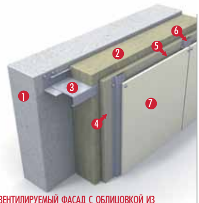
ВЕНТИЛИРУЕМЫЙ ФАСАД С ОБЛИЦОВКОЙ ИЗ ЦЕМЕНТНО-ВОЛОКНИСТЫХ ПЛИТ 1 - несущая конструкция, 2 - PAROC eXtra, 3 - опорная планка, 4 - PAROC WAS 25t или PAROC WAS 35t, 5 - воздушная прослойка, 6 - вертикальные направляющие, 7 - отделка.
